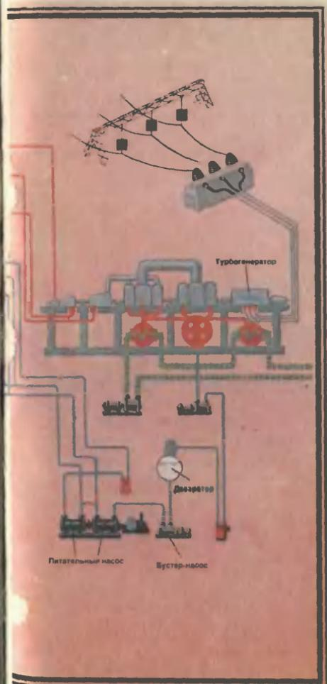
часов. Он установлен на поворотной платформе, что позволяет быстро заменить его новым — на то время, пока восстанавливают первый. Плазма, покинувшая МГД-канал, еще содержит много тепловой энергии. В парогенераторе раскаленный газ нагреет воду, превратит ее в пар, который будет вращать обычный для тепловой электростанции турбогенератор, то есть «на хвосте» МГД-генератора работает еще и обыкновенная тепловая станция. Суммарная мощность такого блока — 500 МВт, а КПД — около 50%.
