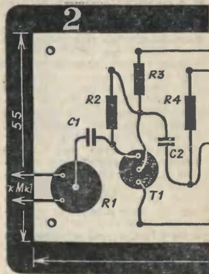
тированы на плате из текстолита (можно гетинакса) размерами 55×165 мм (рис. 2). На рисунке показано расположение деталей и соединения между ними со стороны монтажа. Оба реле и электролитические конденсаторы расположены с другой стороны платы.
