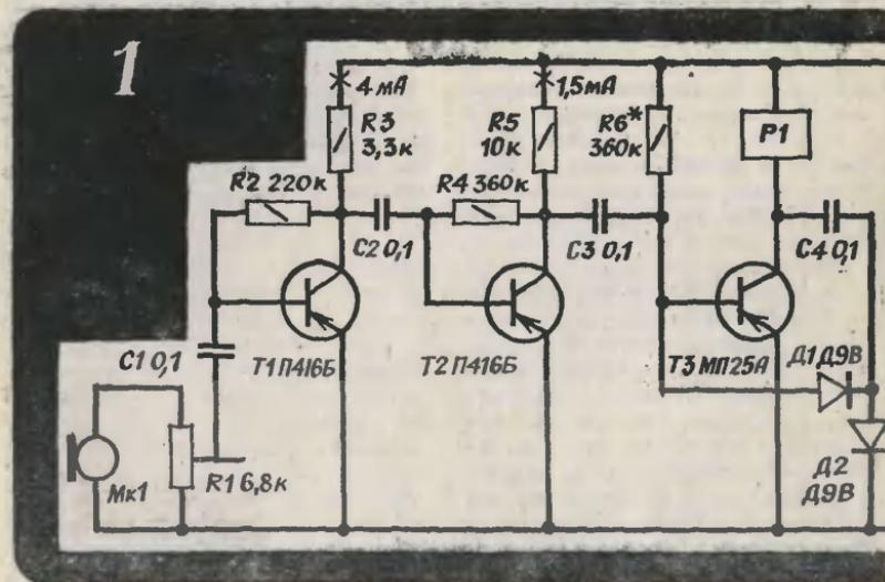
ле и поступает через конденсатор С4 на детектор. В результате детектирования возрастает отрицательное напряжение смещения на базе транзистора, он открывается сильнее, ток в коллекторной цепи возрастает настолько, что реле срабатывает. Своими контактами Р1/1 оно подает сигнал на своеобразный триггер — устройство с двумя устойчивыми состояниями, собранный на реле Р2.
