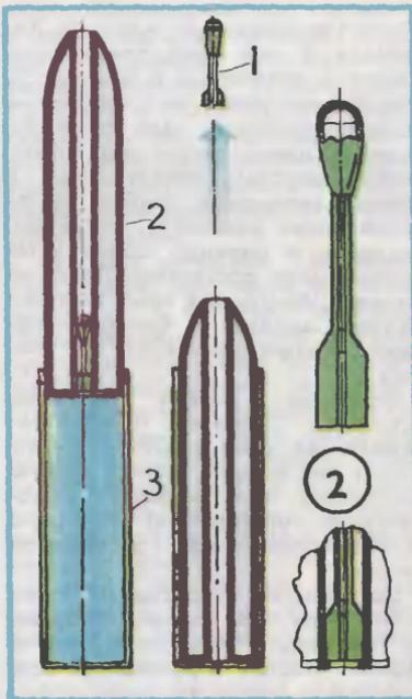
са полностью затвердевает. После этого заготовки можно снимать с болованок. К механической обработке приступайте лишь после выдержки их еще в течение 2—3 суток.
