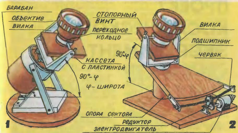
На рисунке показаны два варианта прибора для съемки затмения. Слева астрограф на основе барабана суточного барографа. У астрографа справа в качестве часового механизма суточного гидрирования служит обычный будильник, снабженный самодельным редуктором.
