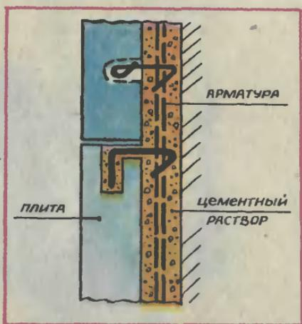
Если заранее предусмотрено, что, например, бетонные панели, приготавливаемые на заводе, должны быть облицованы, задачу решают несколько иначе. В этом случае отпадает надобность в металлических штырях и сетке. Но ручные операции здесь, пожалуй, тяжелее. В плитке сверлят под углом друг к другу отверстия. Потом рабочий берет так называемый пирон — упругую стальную скобу, большим усилием разводит ее
