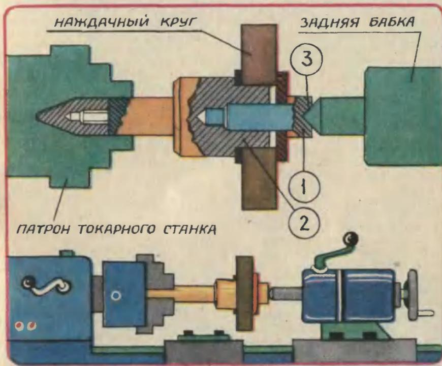
спешить с выводами. Попробуйте вставить в патрон токарного станка круглый наждачный камень. Он наверняка будет «бить» — его рабочая поверхность будет то отдаляться, то приближаться к детали. А здесь биения практически нет. Камень максимально приближен к задней бабке токарного станка и — главное! — поджат ее центром. В «центрах» обрабатывают наиболее точные детали. Это и использовали ребята, выполнив в зажимном винте 1 оправки 2
